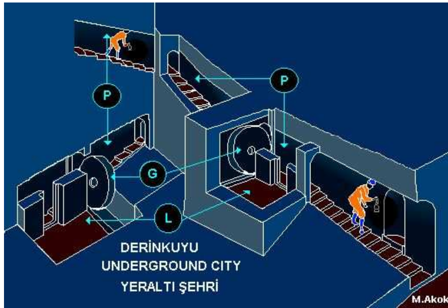
Abbildung 4 : Schema der Rollsteinverschluss - Technik Bild M. Akok
