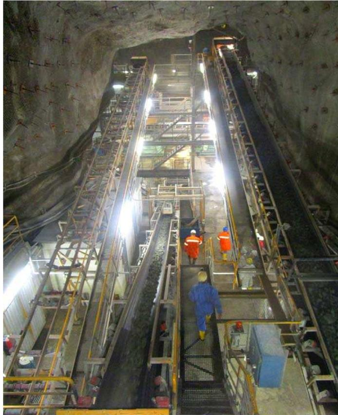
Untertage Aufbereitungsanlage Wolframbergwerk Mittersill
