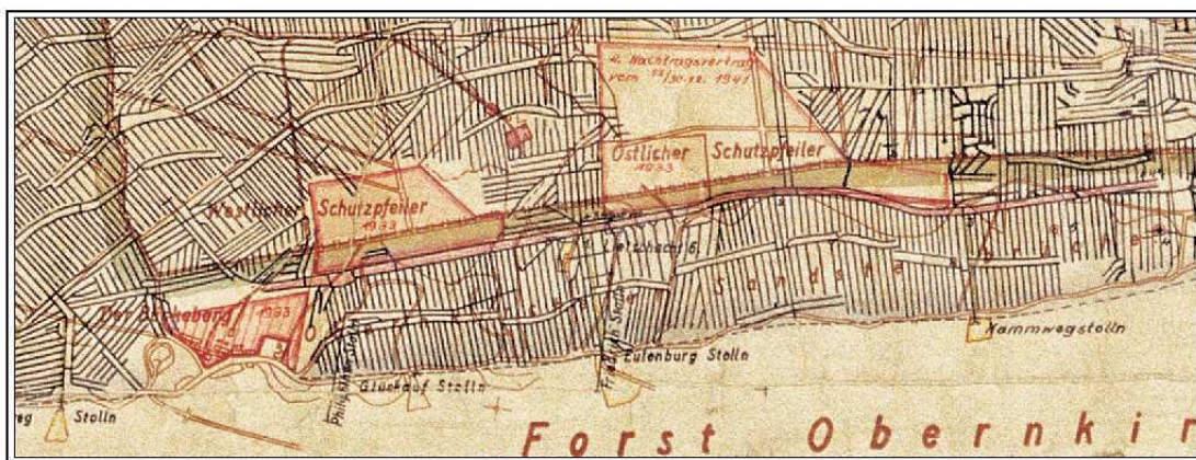
Abb.37 : Ausschnitt aus der Bergbaukarte des Bückeberges mit Reservatsflächen für die Steingewinnung und Entwässerungstollen
